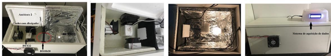
FIGURA 2. Vistas do aparato desenvolvido para o ensaio térmico
