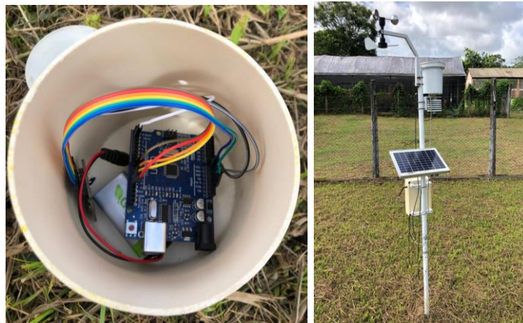
FIGURA 1. Protótipo do Arduino UNO (esquerda) e Estação Meteorológica WRF (direita).
