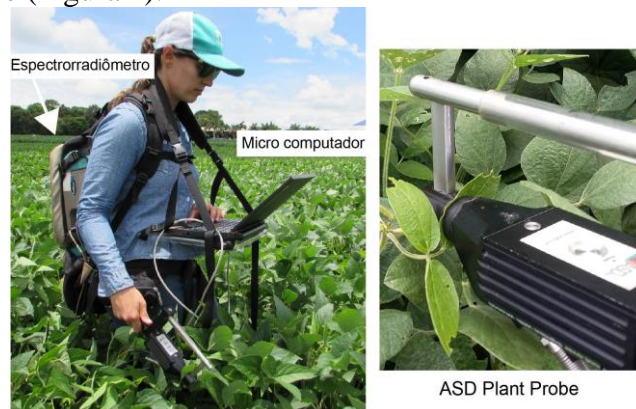
FIGURA 1. Sistema operacional em campo com FieldSpec 3 Jr.
