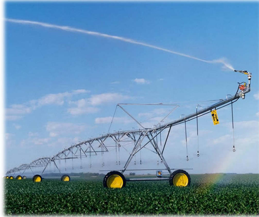
Vão em balanço com canhão final
