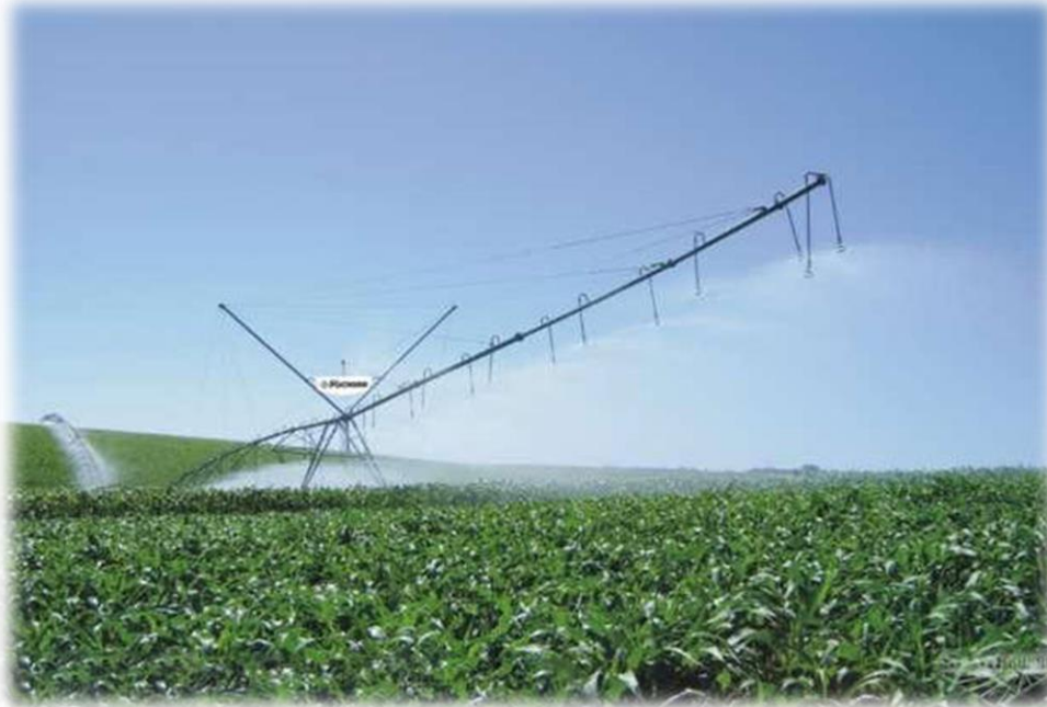
Vão em balanço sem canhão final
