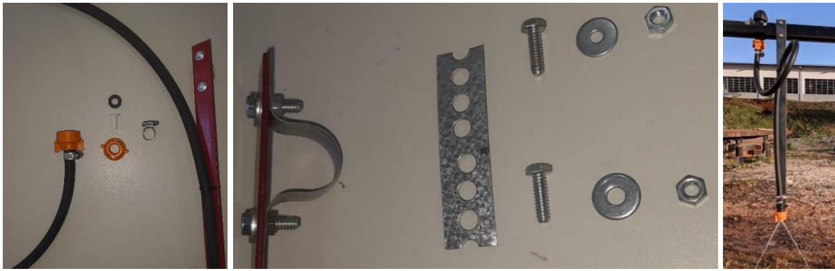
FIGURA 4. A. Componentes de ligação da barra de aplicação ao pingente. B. Componentes necessários para fixar o pingente na barra do pulverizador. C. Pingente para aplicação de fertilizante líquido.
