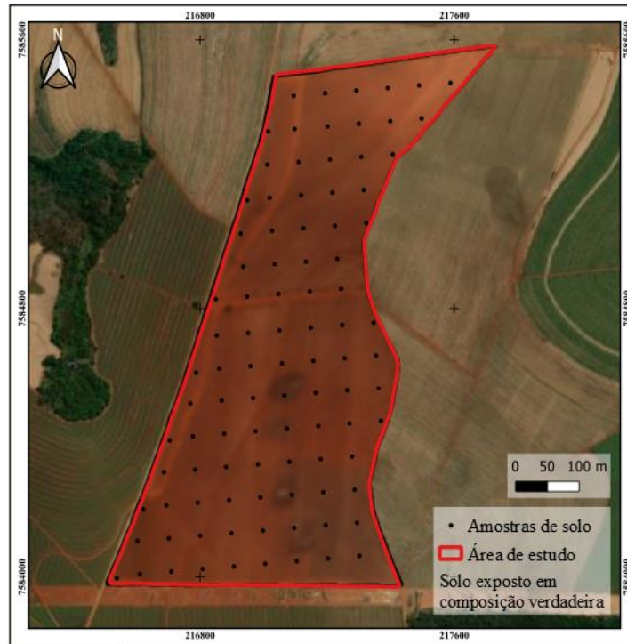
FIGURA 1. Mapa da localização da área de estudo, com os pontos amostrais e mapa dos dados de condutividade elétrica coletado com o sensor EM38.
