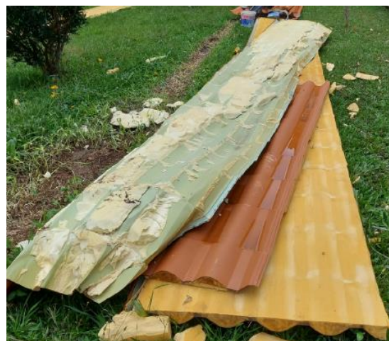
Figura 2. Coberturas de telhas sanduíche danificadas por vento ocorrido em Lages/SC em 21/03/2023.
