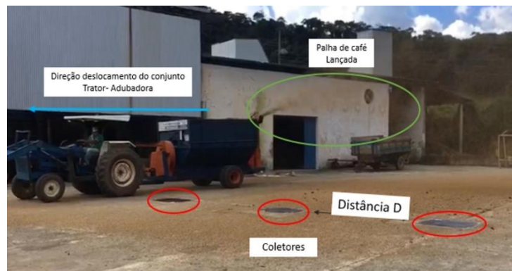
FIGURA 2. Experimento para mensurar o perfil de distribuição lateral de palha de café de uma adubadora a lança utilizada para regiões de montanha
