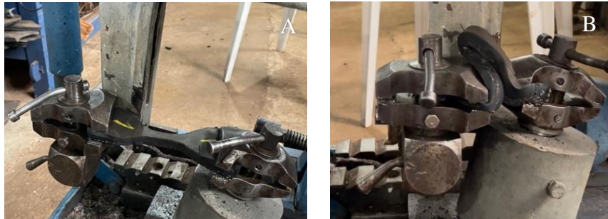
Figura 2: Amostra fixada ao mecanismo de tração e flexão.
