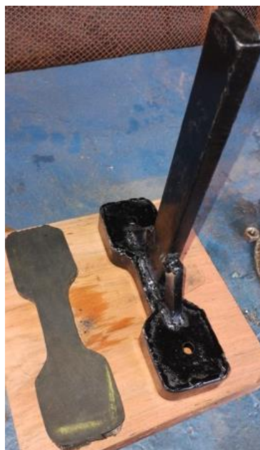
Figura 1: Ferramenta utilizada como molde, para o corte da borracha
