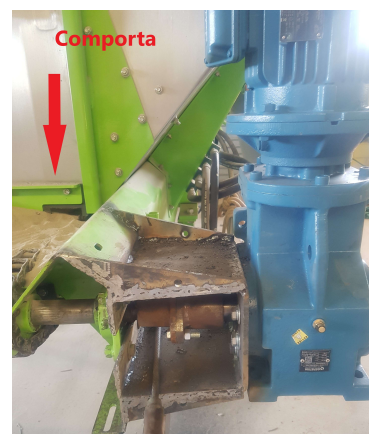
FIGURA 1a : Sistema de proteção e máquina preparadas para o teste e FIGURA 1b : comporta de saída do material e motor e redutor ligados ao eixo da esteira.
