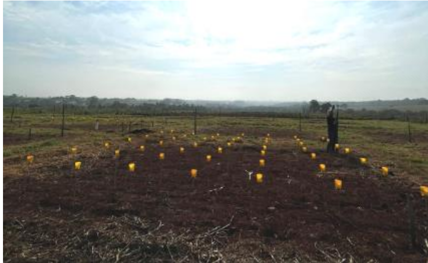
FIGURA 1. Teste de uniformidade e eficiência de aspersores em parcela experimental.
