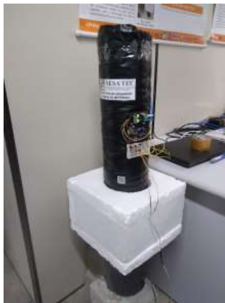
FIGURA 1. Protótipo de avaliação térmica de materiais do NESA 3 TEC.
