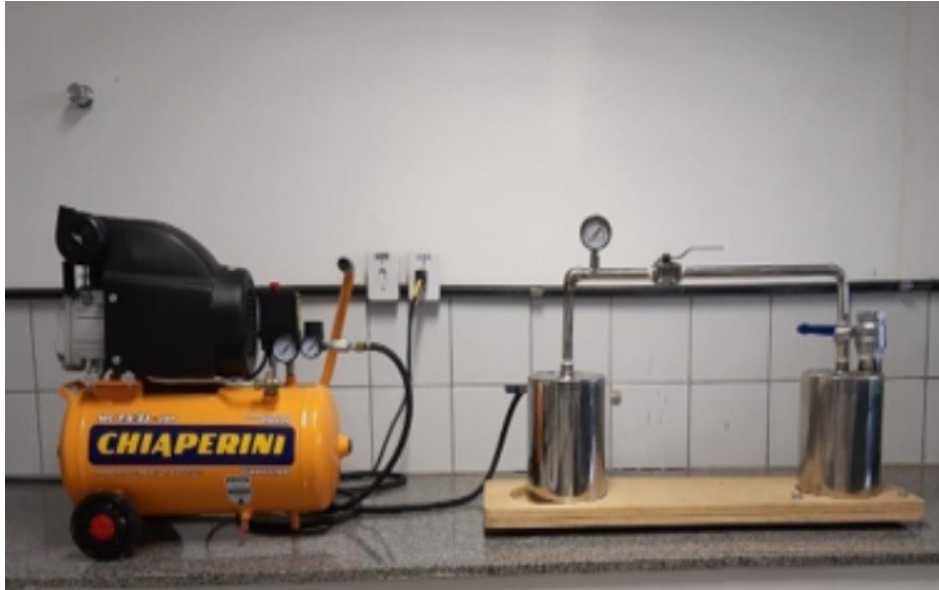
FIGURA 2. Picnômetro instalado no compressor.
