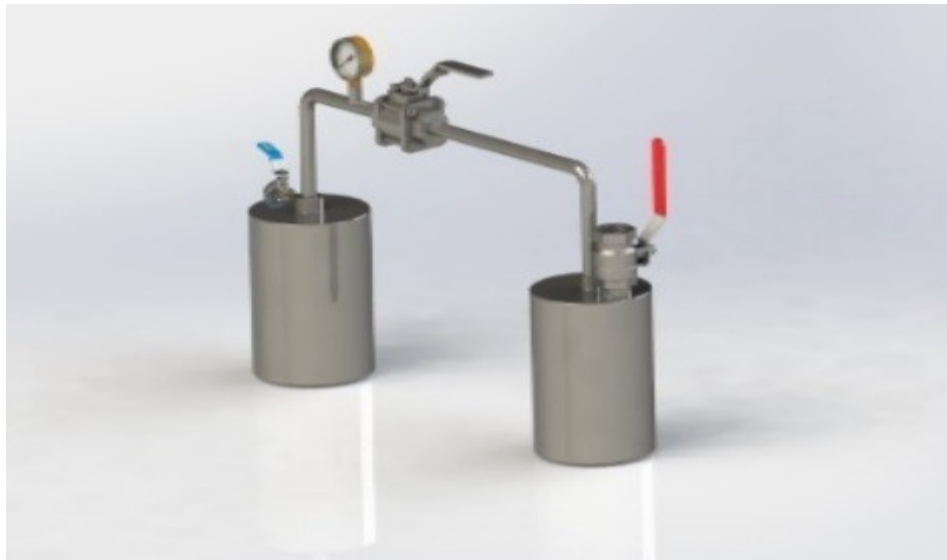
FIGURA 1. Vista lateral dos cilindros de compressão do protótipo picnômetro a ar em 3D.
