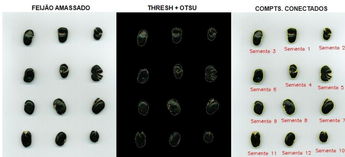
FIGURA 2. Resultados do redimensionamento, da limiarização e da segmentação pela técnica proposta pelo trabalho para o processamento da imagem com feijão amassado.
