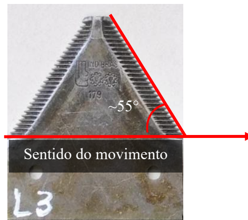
FIGURA 3. Representação da medida do ângulo de ataque das lâminas
