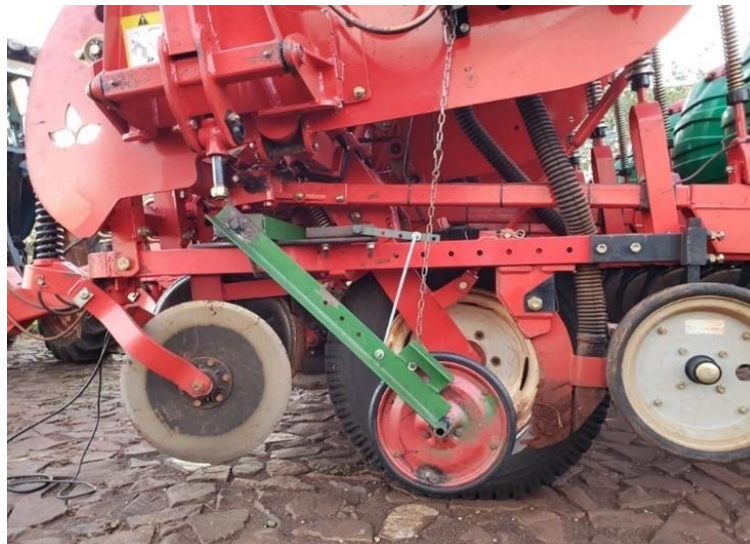
Figura 2. Dispositivo para monitorar a profundidade da haste acoplado a semeadora.
