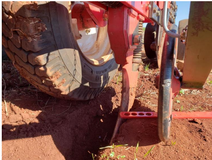
Figura 3. Medição da profundidade real da haste feita a campo para calibração do sensor.
