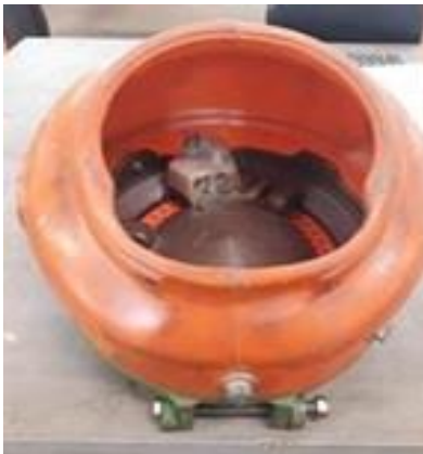
FIGURA 1. Dosador de disco alveolar horizontal A.
