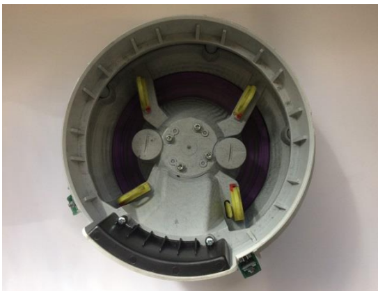
FIGURA 2. Dosador de disco alveolar horizontal B.
