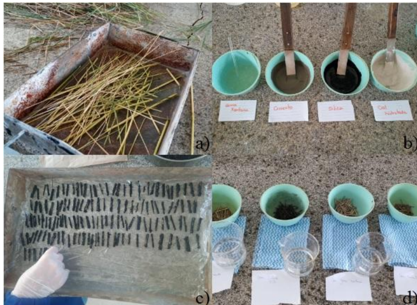
FIGURA 1: Processo de impermeabilização da fibra. a) Limpeza do capim Annoni; b) Misturas das soluções de tratamento; c) Disposição das fibras tratadas para secagem; d) Ensaio de absorção de água.
