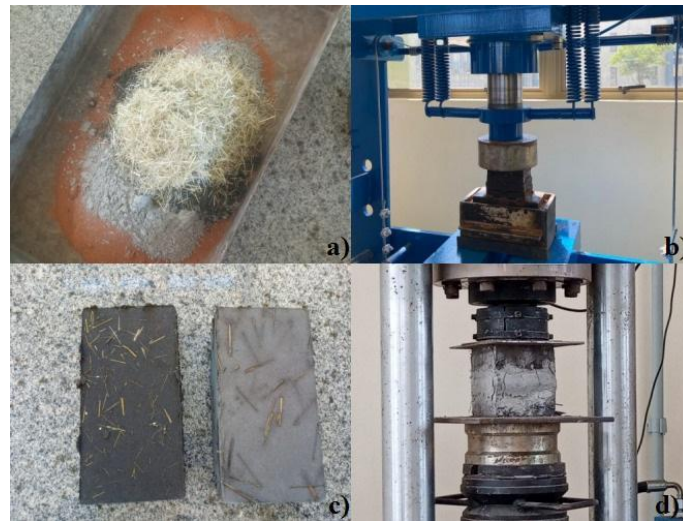
FIGURA 1: Processo de produção dos tijolos. a) Mistura solo-cimento-sílica-capim; b) Confecção do tijolo na prensa; c) Tijolos confeccionados; d) Rompimento dos tijolos.
