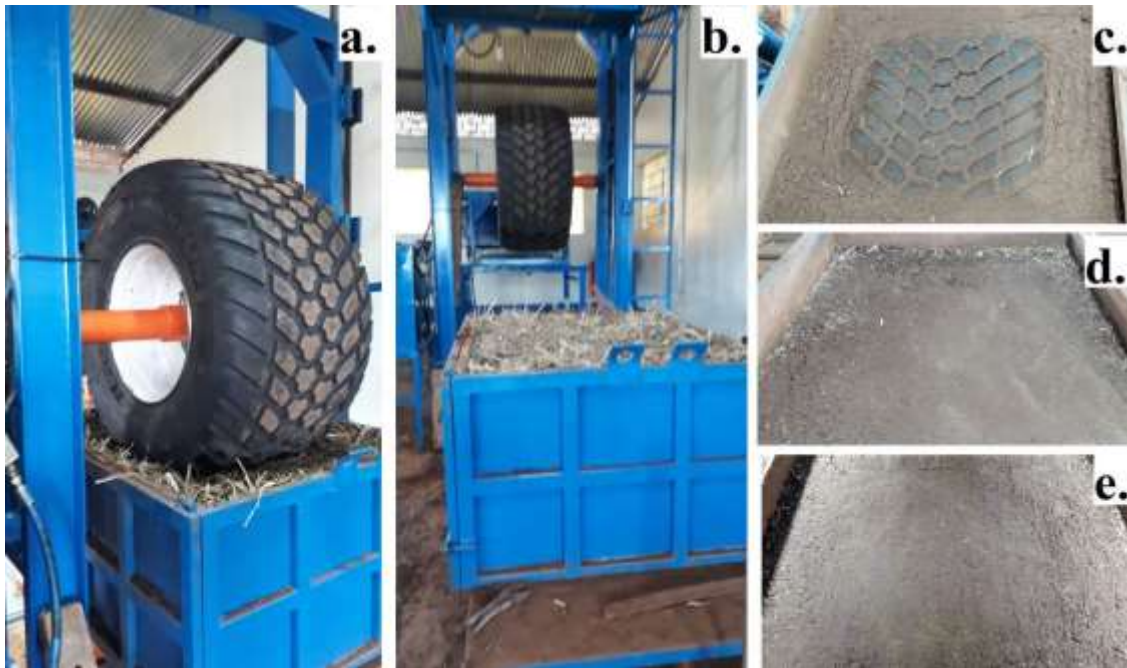
FIGURA 1. Unidade Fixa de Ensaio de Pneu UFEP; a.) Ensaio de interação rodado-solo em superfície com 15 \text{ Mg ha}^{-1} de palhicho em cobertura; b.) amostra de solo com 15 \text{ Mg ha}^{-1} de palhicho antes da aplicação da carga de 50,52\text{kN} ; c.), d.) e e.) apresentam a superfície do tanque após aplicação de carga de 50,52\text{kN} com 0, 15 e 30 \text{ Mg ha}^{-1} de palhicho em cobertura, respectivamente.
