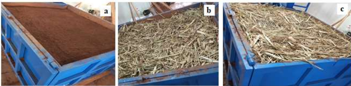
FIGURA 2. Tanques de solo padronizados montados na UFEP; a) amostra de solo descoberto 0 \text{ Mg ha}^{-1} ; b) amostra de solo com 15 \text{ Mg ha}^{-1} de palhicho; c) amostra com 30 \text{ Mg ha}^{-1} de palhicho na superfície.
