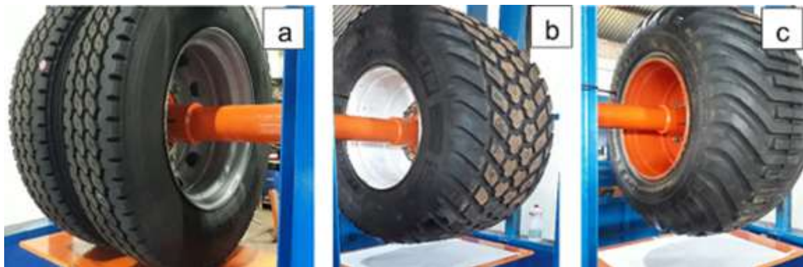
FIGURA 1. Modelos de pneus utilizados nos ensaios em superfície rígida. (a.) P1 - construção radial composto por um rodado duplo (2 x 275/80R22.5); (b.) P2 - construção radial (600/50R22.5); (c.) P3 – construção diagonal (600/50-22.5).
