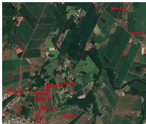
FIGURA 1. Pontos de instalação dos componentes da rede LoRa/LoRaWAN na cultura do milho.
