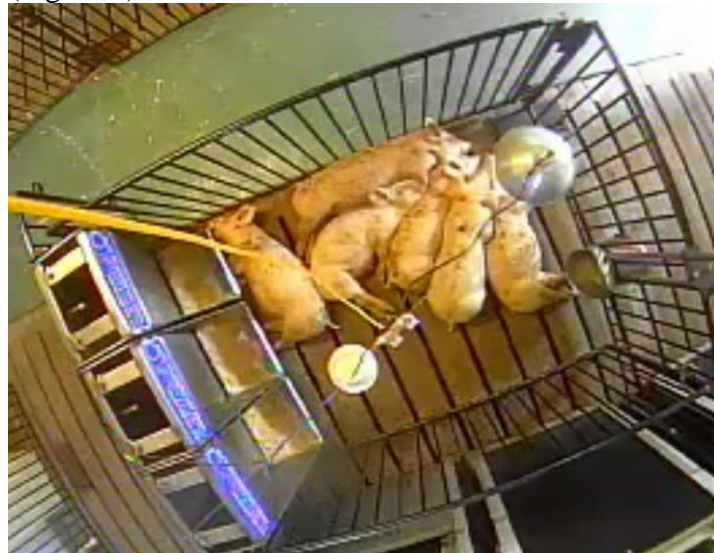
Figura 2 - Estrutura da baia: três comedouros à esquerda, um bebedouro à direita. Microfone e controladores de temperatura ao centro.
