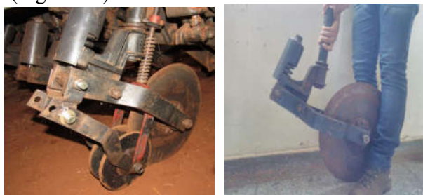
FIGURA 1. Mecanismo de corte de palhada adaptado (A) e o disco original da semeadora (B).
