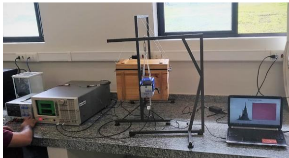
FIGURA 2. Configuração experimental para análise FRF.
