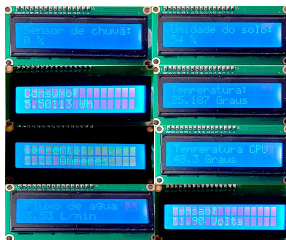
FIGURA 2. Leitura dos sensores exibidos no display LCD.
