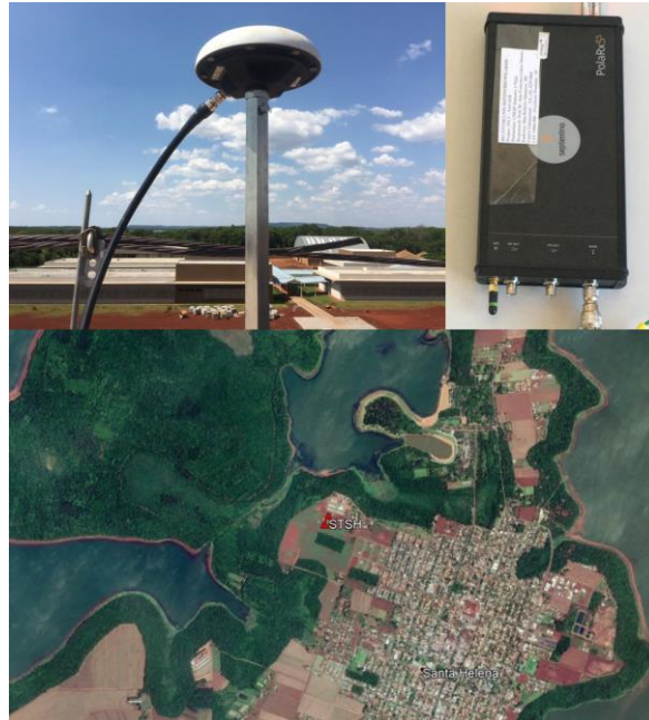
FIGURA 2. Antena Septentrio PolaNt* MC, receptor Septentrio PolRx5S e localização aproximada da estação STSH.
