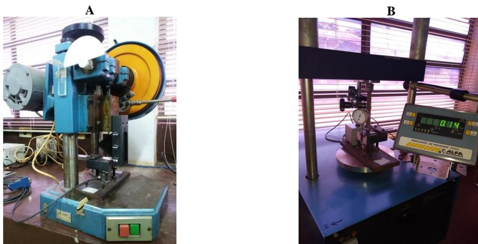
Figura 1. A- Módulo de Cisalhamento de Plantas (MCP); B- Mensuração da deformação elástica do dispositivo de mensuração da força
