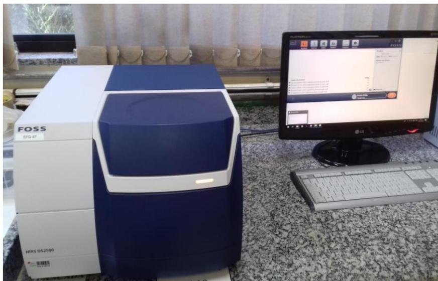
FIGURA 1. Espectrofotômetro de Infravermelho Próximo (NIRS).
