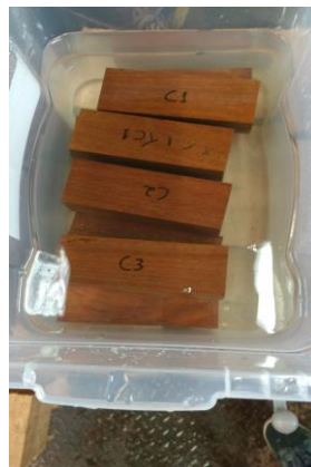
FIGURA 2. Corpos de prova em processo de saturação em recipiente com água.
