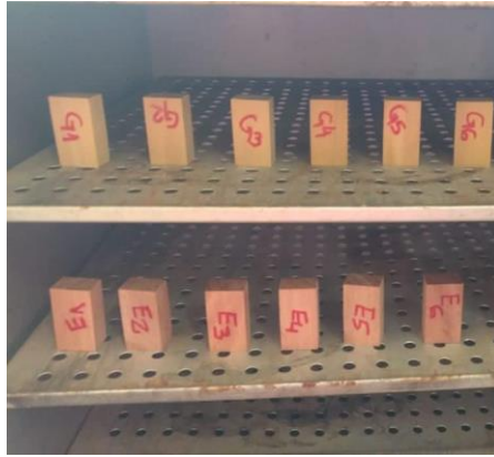
FIGURA 3. Secagem de corpos de prova em estufa.
