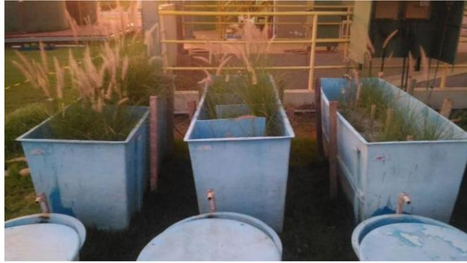
FIGURA 1. Sistemas Alagados Construídos de Escoamento Horizontal Subsuperficial (SACs-EHSS) com diferentes configurações plantados com *Pennisetum setaceum* (Capim do Texas).
