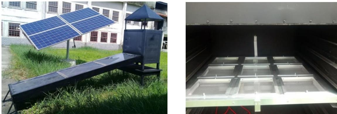
FIGURA 1. Secador híbrido solar-elétrico a) câmara de secagem b) bandeja com cestos removíveis
