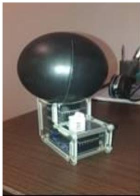
Figura 2. Equipamento montado para o registro da temperatura do ar, temperaturas de globo negro e umidade relativa.
