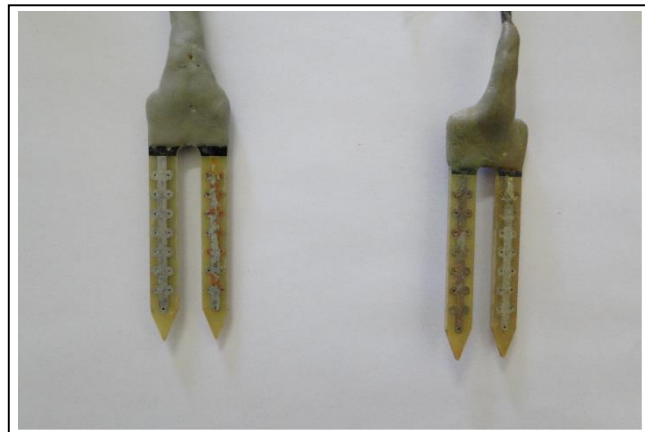
FIGURA 7. Sondas de cobre depois de isoladas e oxidadas.
