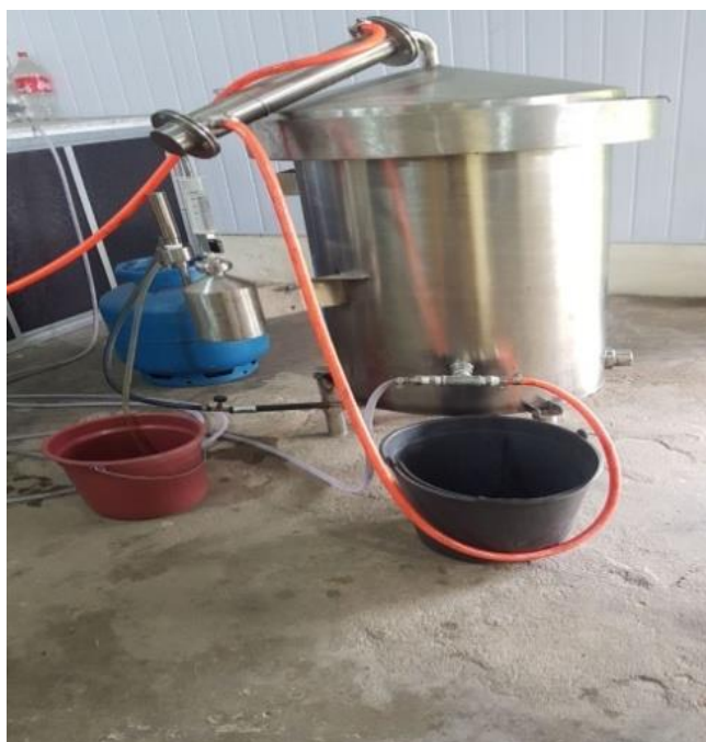
Figura 5: Destilador D10-Linux, utilizado para a extração de óleo da citronela.
