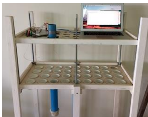
FIGURA 4. Ensaio em laboratório, para uma única amostra, com uma proveta automática e dispositivo eletrônico para avaliação da performance do sistema de coleta, armazenamento de dados, e rotina de controle.
