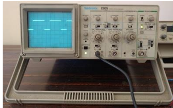
FIGURA 2. Comprovação da frequência obtida pelo circuito integrado NE555 com o uso de um osciloscópio.
