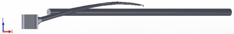
FIGURA 1. Geometria final do ramo de café e da haste da colhedora.
