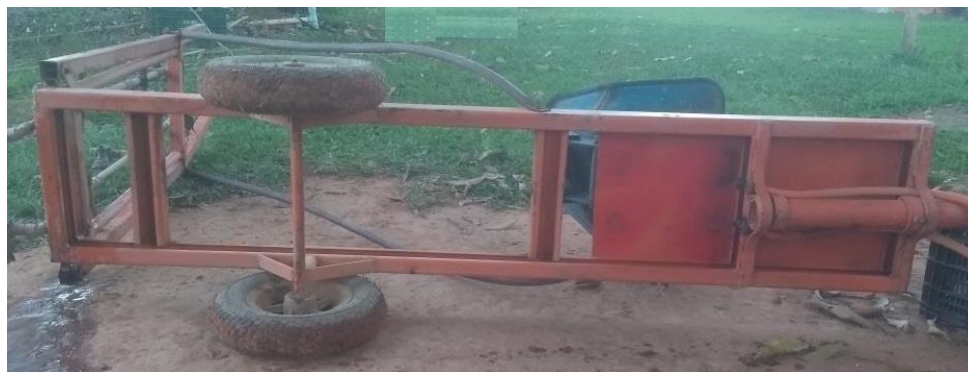
FIGURA 1. Chassi, eixo traseiro com rodado, banco e barras.
