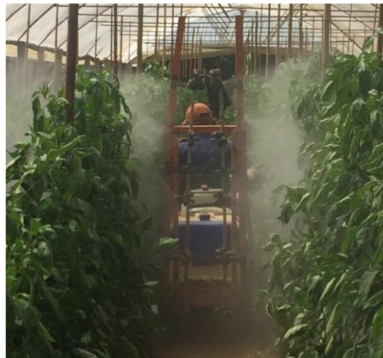
FIGURA 2. Micropulverizador autopropelido sendo testado na cultura do pimentão cultivado em estufa.
