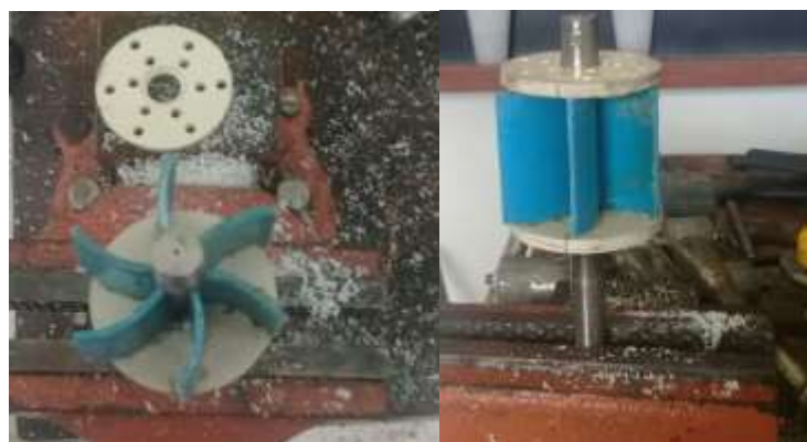
FIGURA 2. Detalhes da construção da turbina de PVC.
