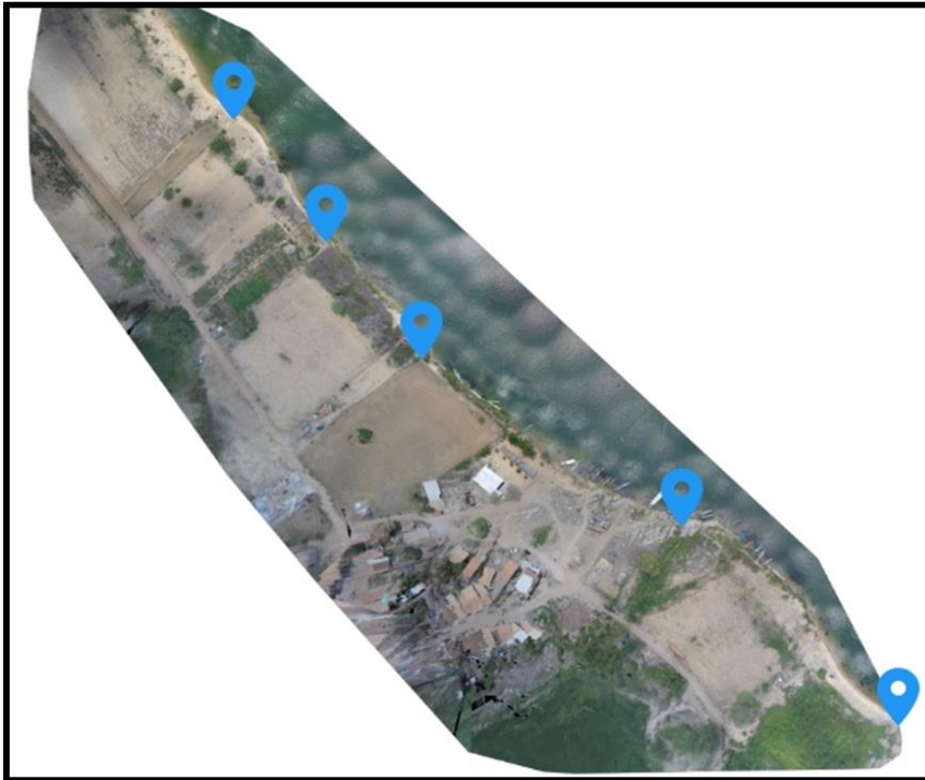
FIGURA 1. Mosaico 1 com pontos de captação detectados, Gararu-SE. Distância de amostragem do solo (GSD): 2.41 cm.
