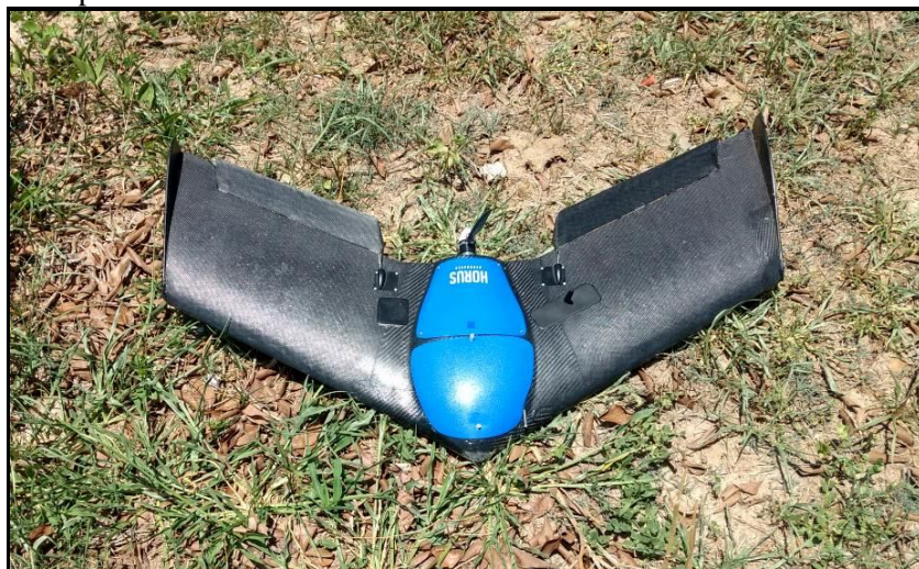
FIGURA 1. Veículo Aéreo Não Tripulado (VANT) modelo Isis, da empresa Horus Aeronaves, utilizado para o levantamento aéreo da área de estudo.
