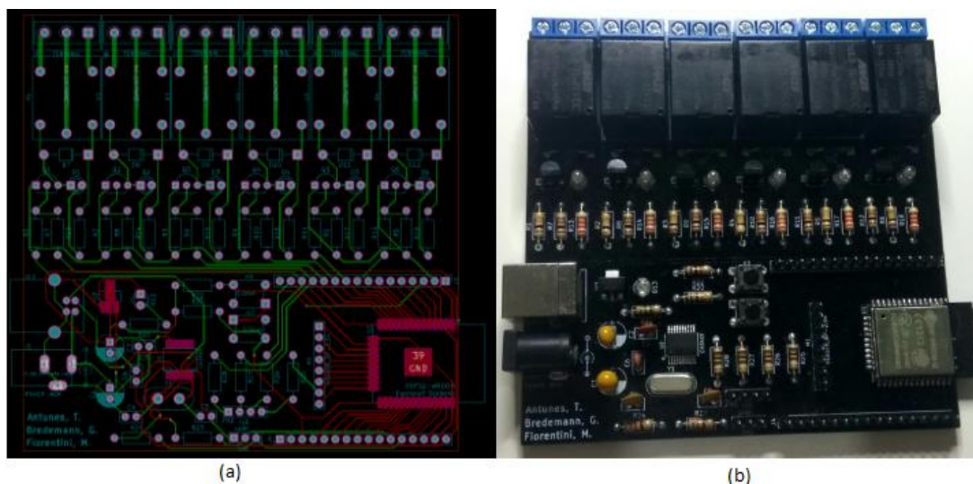
FIGURA 2. (a) Layout do módulo de controle central, (b) Placa módulo de controle central.
