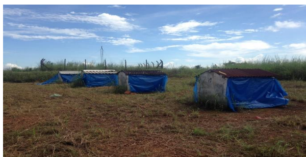
FIGURA 1 – Abrigos individuais, cobertos nas laterais por lona, com os quatro tratamentos apresentados. Contendo no interior de cada um dos abrigos globo negro, termohigrômetro.
