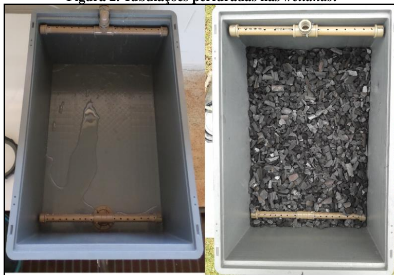
Figura 2. Tubulações perfuradas nas wetlands.
