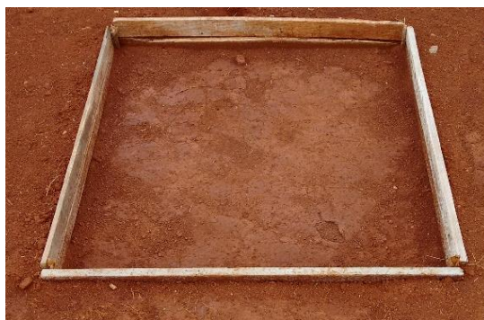
Figura 1. Vala de infiltração para disposição de água residuária de laticínios.
