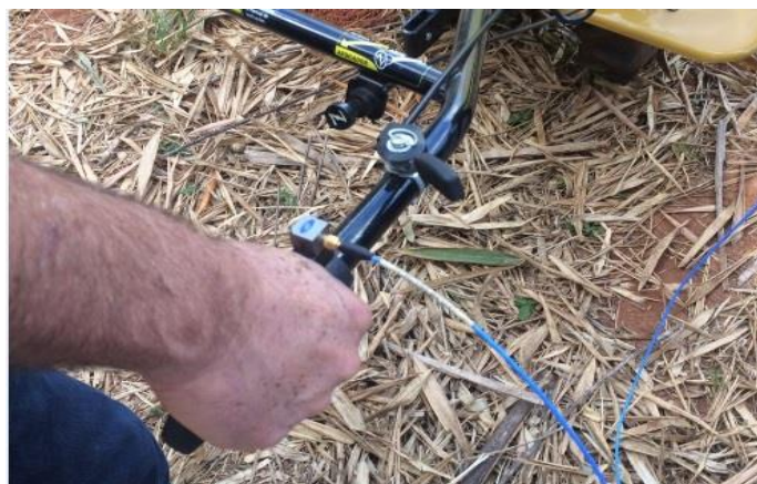
FIGURA 4. Fixação real dos acelerômetros.
