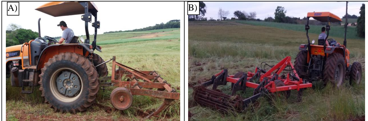
FIGURA 1. A) Subsolador dotado de disco de corte e rolo destorroador, B) Subsolador convencional
