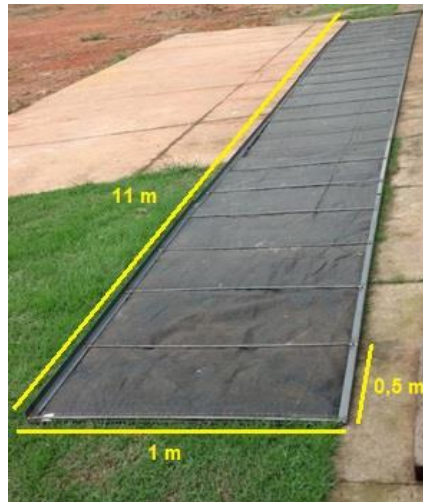
FIGURA 1. Coletor confeccionado para coleta da palha conforme a norma ASAE S396.2 (1998).
