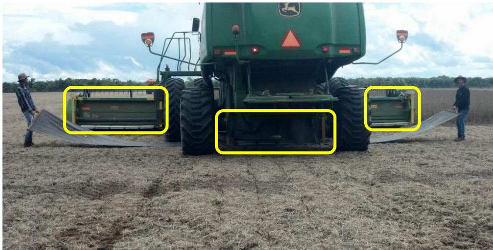
FIGURA 2. Posição do coletor para coleta da palha (M3) da colhedora e detalhe do posicionamento das seções de bandejas coletoras do SIMEPECO (M2).
