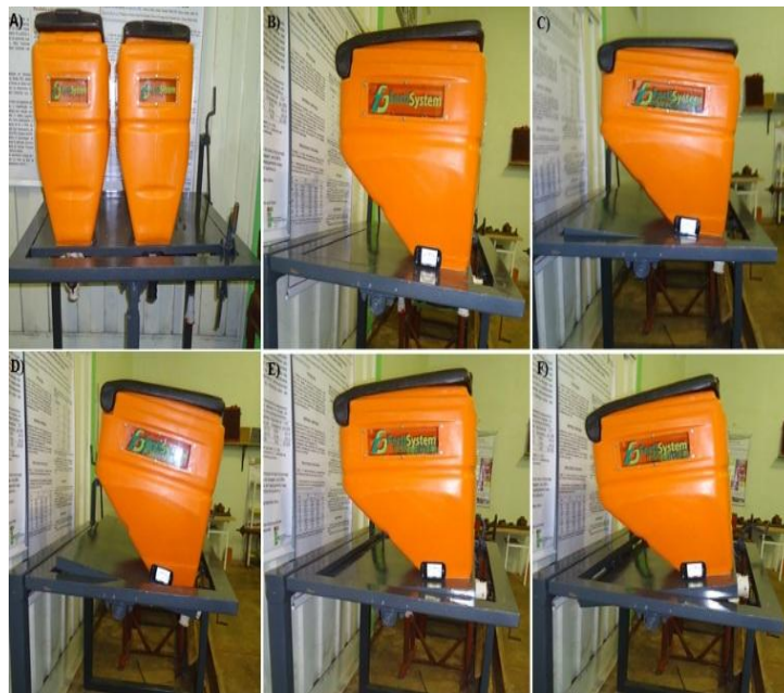
FIGURA 1. A) Bancada de testes; B) Nível; C) 5° Active; D) 10° Active; E) 5° Declive, F) 10° Declive
