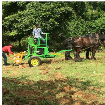
Figura 7: Prática uso no campo de maquinaria agrícola com animais projeto de cinzel e bois com cavalos de esboço rotovo. Relação animal, implementar e solo
